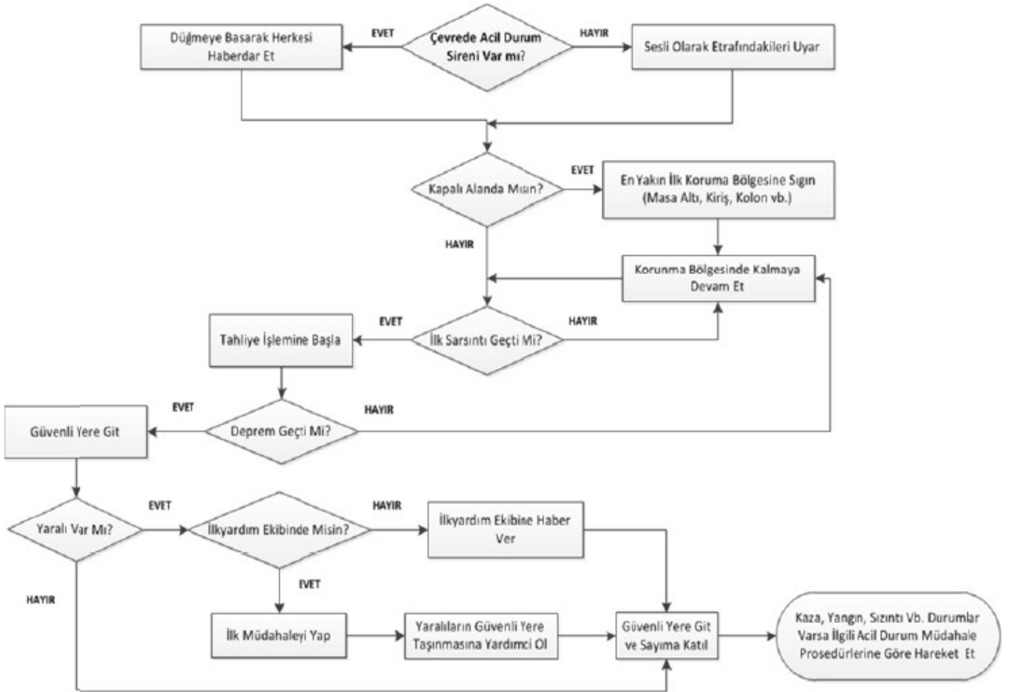
Şekil Deprem için acil durum müdahale yöntemi
